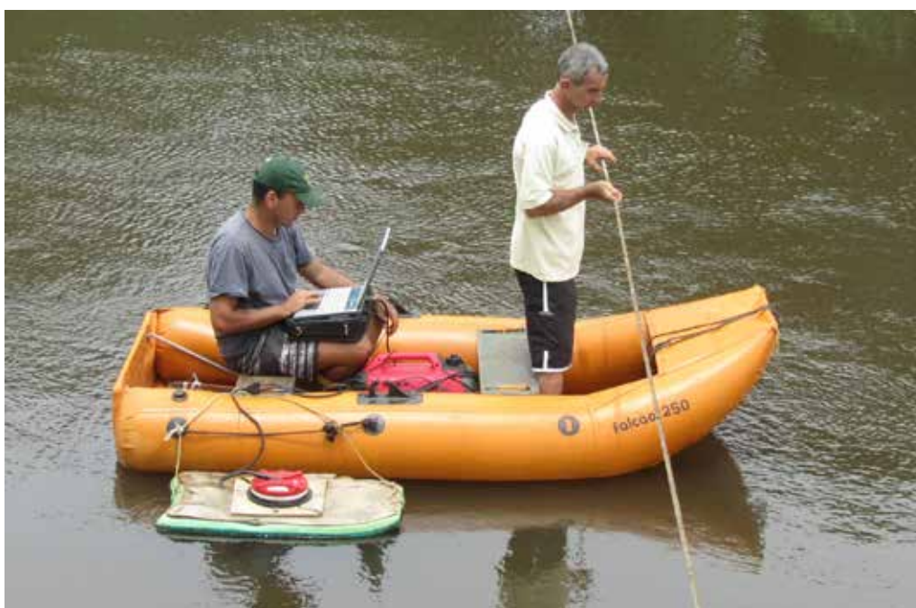
Medição de vazão no Rio Juqueriquerê, Caraguatatuba, SP, Brasil.
