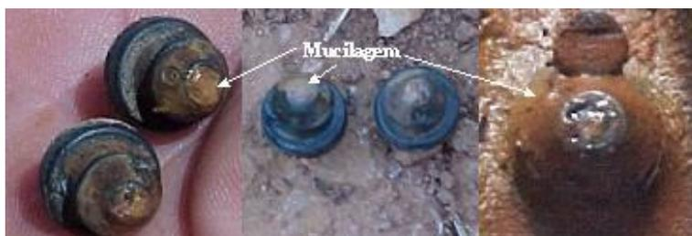
Figura 7 - Formação de mucilagem na entrada dos gotejadores e nas paredes internas das tubulações.
