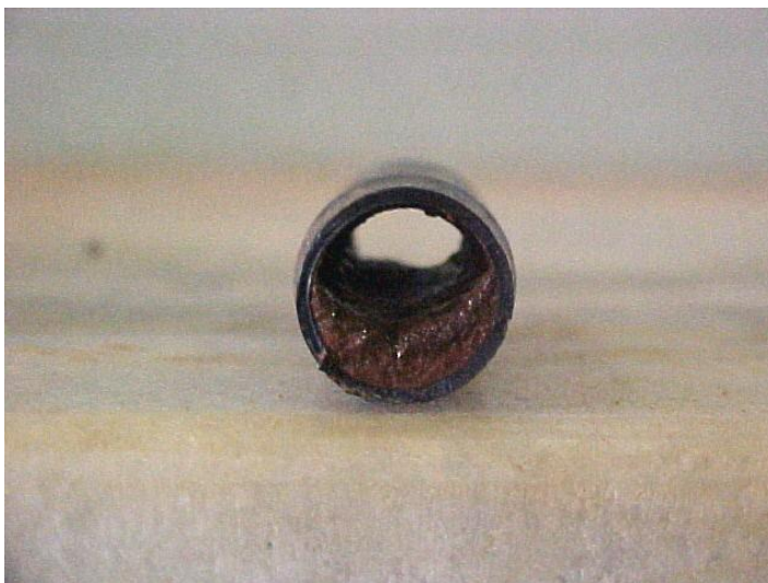
Figura 1 – Corte transversal mostrando sedimentação no final de uma linha lateral.
