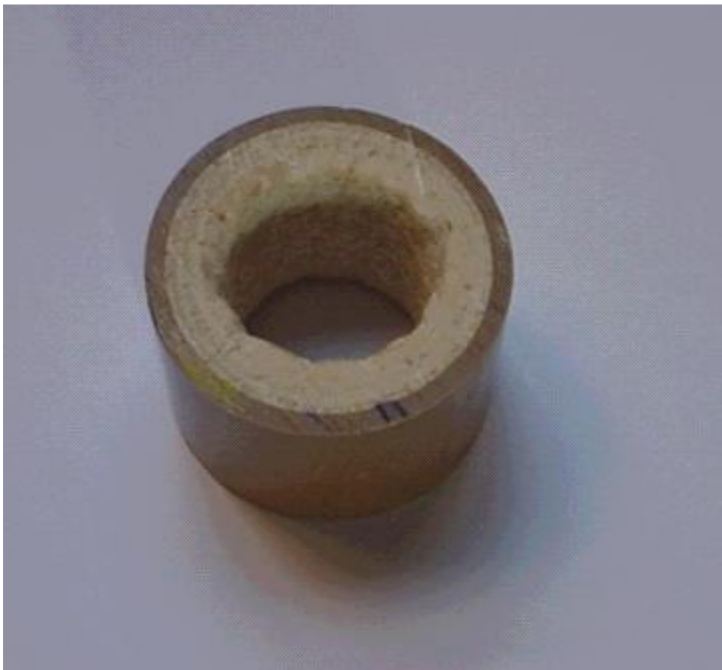
Figura 2 – Incrustações provocadas pela precipitação de cálcio.
