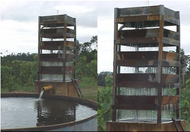
Figura 3 – Aerador tipo tabuleiro e tanque circular de sedimentação.
