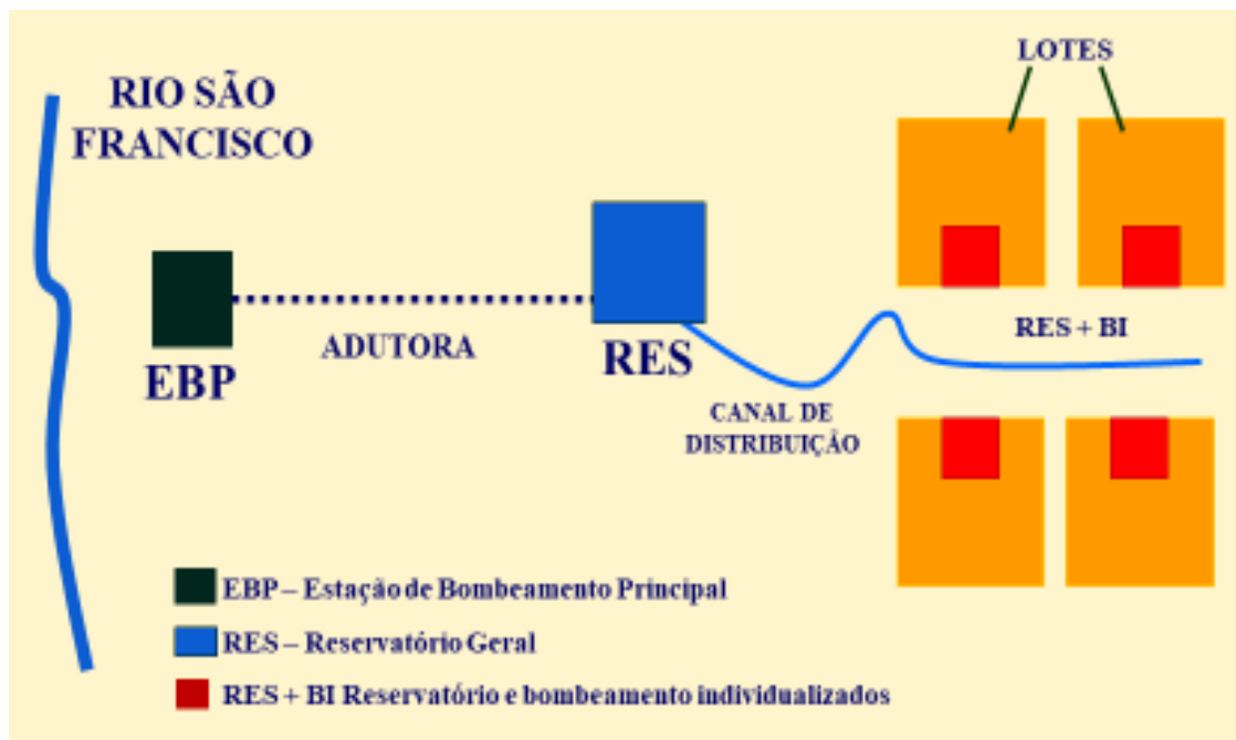
Figura 3. Modelo esquemático de funcionamento do projeto público de irrigação (PPI) Mandacaru após a conversão dos sistemas.
